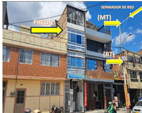
Figura 3 ubicación media tensión (MT) baja tensión (BT) y separador de red poste cerca al predio
