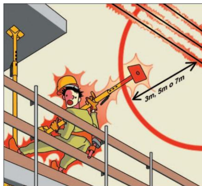
Figura 1 distancia de seguridad línea eléctrica
